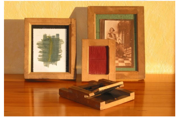
Papier salé viré à l'or / Châssis-presse pour tirage contact
