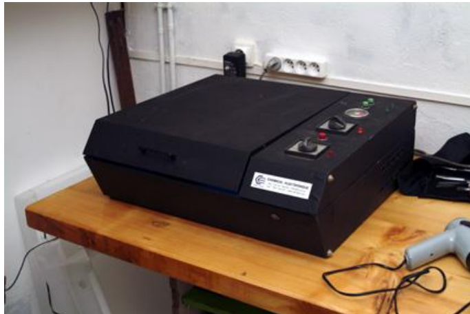
Banc UV avec aspiration sous vide pour créer le contact. Insolation de Van Dyke
