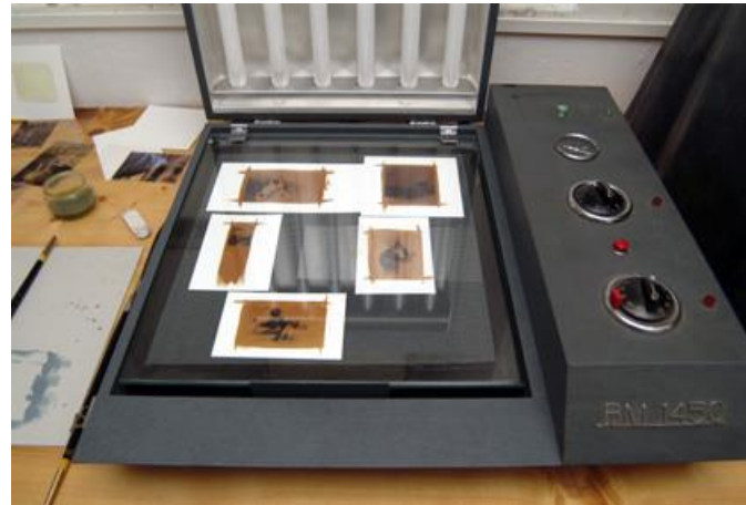
Banc UV avec aspiration sous vide pour créer le contact. Insolation de Van Dyke
